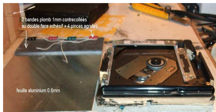
Platine du drive fixée sur 2 plaques contreplaqué 5mm, 3 cales bois en hauteur, 4 vis sur entretoises laiton
