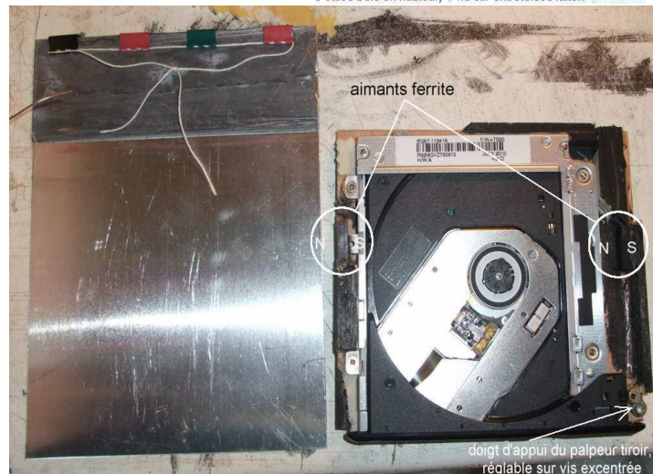
Platine du drive fixée sur 2 plaques contreplaqué 5mm, 3 cales bois en hauteur, 4 vis sur entretoises laiton
