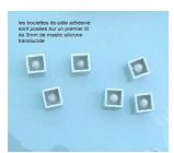
il s'agit ici de boulettes "nature", (les boulettes quartzées se sont avérées problématiques) - repérez bien visuellement la taille des boulettes qui font environ 8 mm, posées sur un premier lit de mastic silicone transparent d'environ 3 mm.
